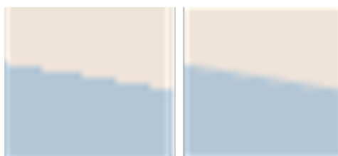
Exemple d'une bordure de polygone sans anticrénelage (gauche) et avec anticrénelage (droite)
